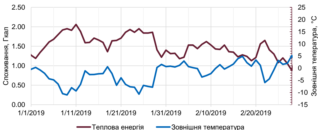
Рисунок 5.14 - Споживання теплової енергії залежно від зовнішньої температури житловою будівлею з погодним регулюванням
