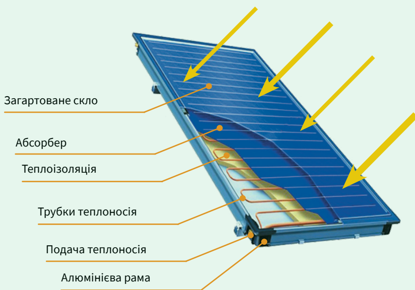
Рис. 3. Побудова трубчастих вакуумних та плоских сонячних колекторів для отримання гарячої води. https://bit.ly/2QOi9F2
