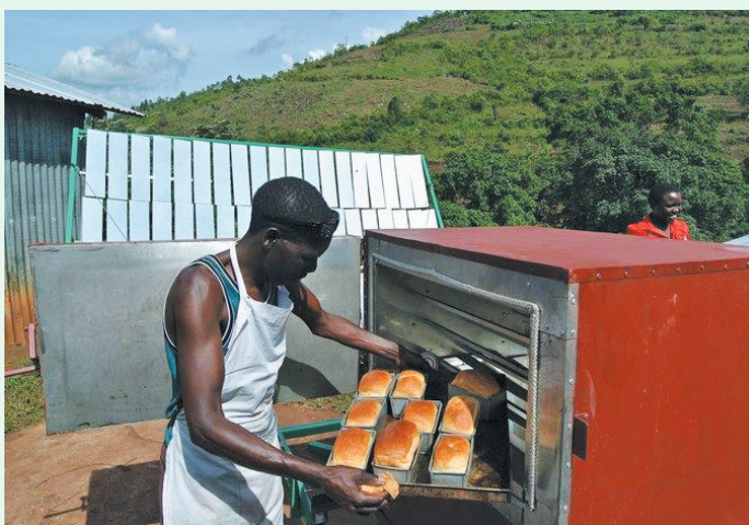
Фото 3. Використання сонячного тепла в Кенії для випічки хліба. В геліоконцентраторах та печах компанії GoSol температура всередині перевищує 300°C. https://gosol.org/kenya
