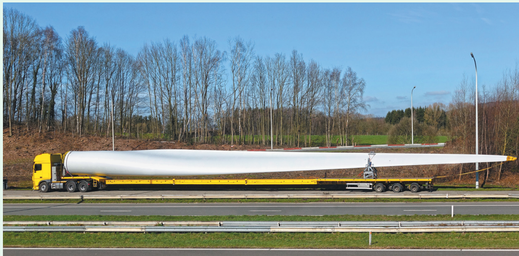
Фото 24. Доставка лопаті вітрогенератора до місця складання
