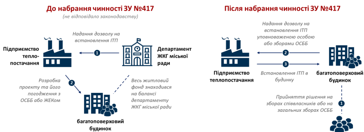
Рисунок 10. Отримання дозволу на встановлення ІТП в багатоповерховому будинку для ТКЕ
